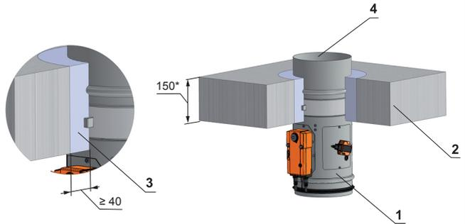
\* min. 110 - Concrete/ min. 125 - Aerated Concrete
