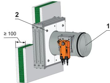
**Installation - entfernt von Massivdecken
