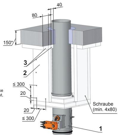
\* min. 110 - Beton/ min. 125 - Porobeton
