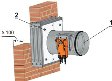
**Installation an Leichtbauwänden**
